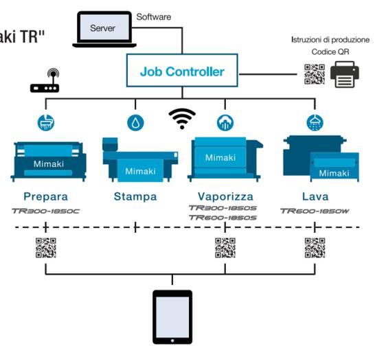
L'operatore riceve le istruzioni per la gestione delle macchine leggendo il codice QR dal tablet.
