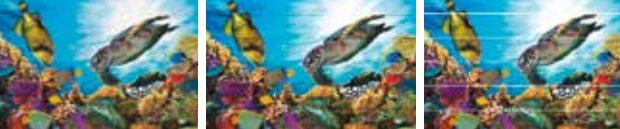
Posizione di rilascio bidirezionale errata Sovrapposizione / striature nere (alimentazione carta insufficiente) Spazi vuoti / striature bianche (alimentazione carta eccessiva)
